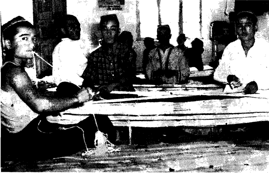
Ryc. 6. „Rezerwacja” — przewiązywanie pasm osnowy przed oddaniem ich do farbowania. Przedsiębiorstwo przemysłu jedwabniczego „Atlas” w Margelanie
